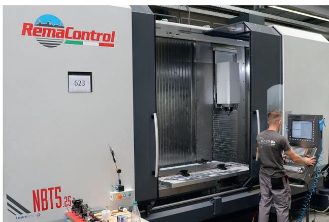
3 Das von teamtec gelieferte Fahrständer-BAZ RemaControl Newton Big NBT5-25 begeistert bei MBS die Mitarbeiter. Es lässt sich flexibel für die präzise Zerspannung von Groß- und Kleinteilen einsetzen (© teamtec)
