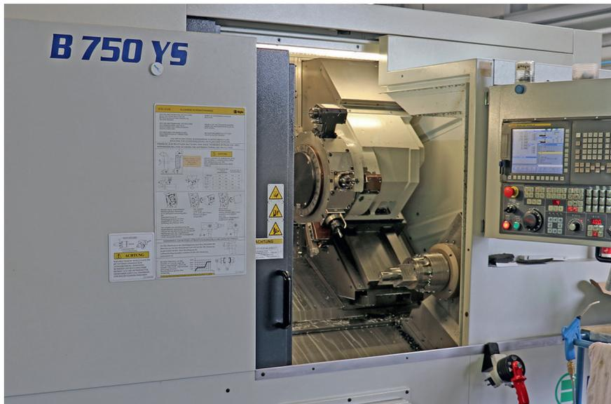
4 Im neuen MBS-Werk in Gründau-Lieblos stehen auch vier Biglia-Drehzentren, die ebenfalls von teamtec geliefert wurden; die neu überarbeitete B 750YS ist ein multifunktionales Drehzentrum mit Y-Achse, angetriebenen Werkzeugen, C-Achse und Gegenspindel (© teamtec)
